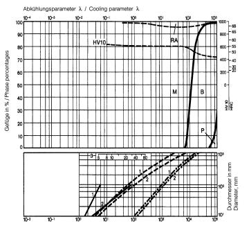
Kühlzeit von 800°C auf 500°C in Sek. / Time of cooling from 800°C to 500°C in seconds
