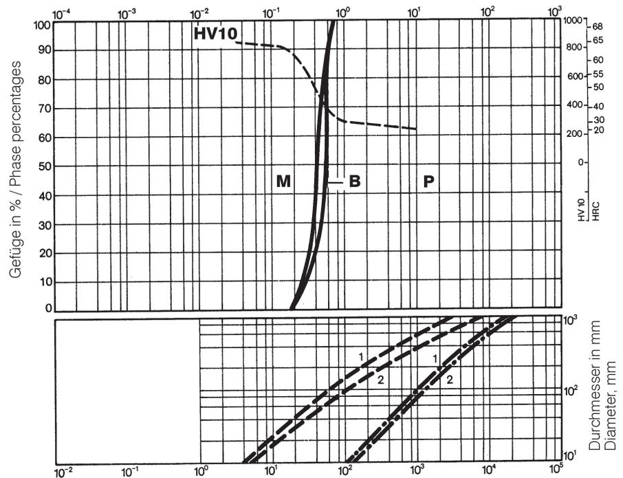
Kühlzeit von 800°C auf 500°C in Sek. / Time of cooling from 800°C to 500°C in sec.
