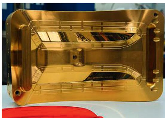
Molde con recubrimiento TiN-ultrafine para inyección de plástico (cubiertas de plástico para automoción)
