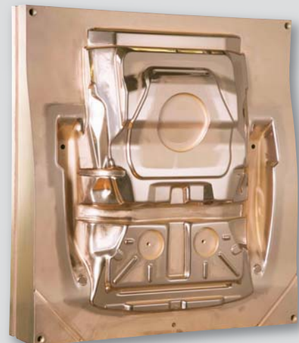
Matriz de conformación D2, recubrimiento Duplex-VARIANTIC; material de trabajo: acero 1.0335 laminado en caliente.
